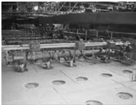
Рис. 4. Пример установки сводовых горелок.
