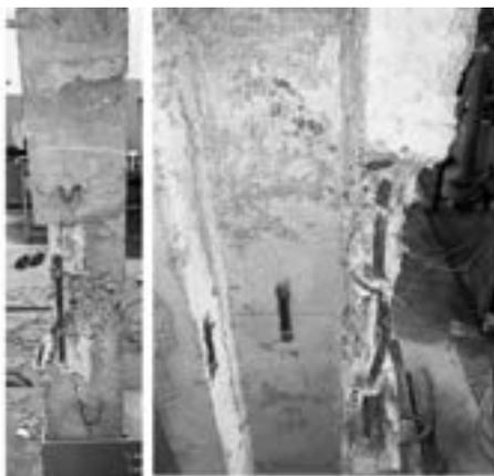
Рис. 5. Колонны после испытаний.
