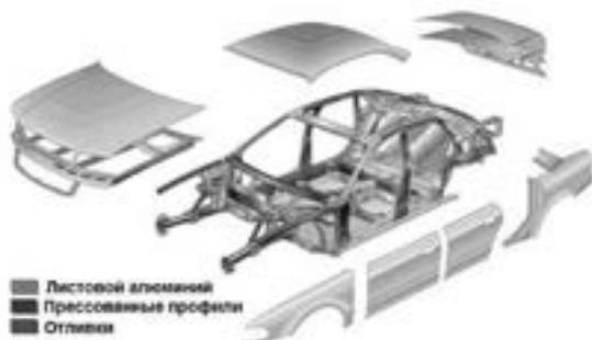
Рис. 1. Элементы кузова легкового автомобиля.
