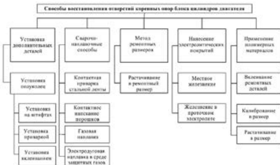
Рис. 1.1. Классификация способов восстановления опор коренных подшипников блока цилиндров
