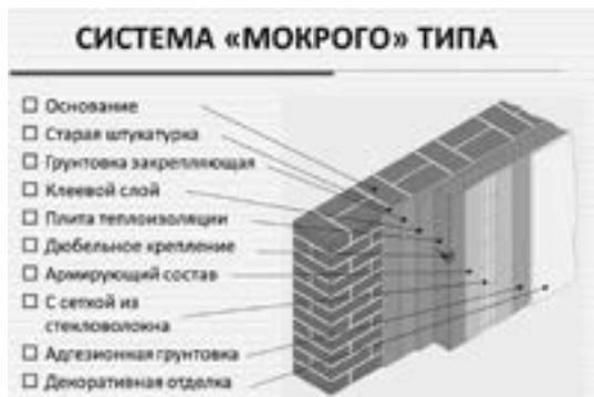
Рис.7. Система «скрепленной» теплоизоляции фасадов
